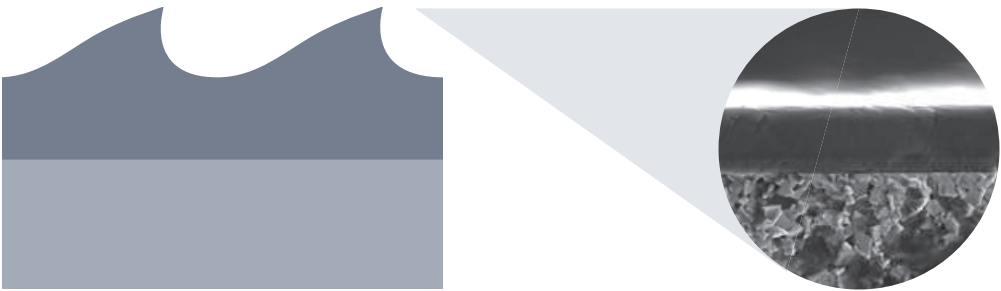
Многослойное покрытие Твердость: 3100-3300 HV 0,05 Общая толщина покрытия: 3-5 мкм
